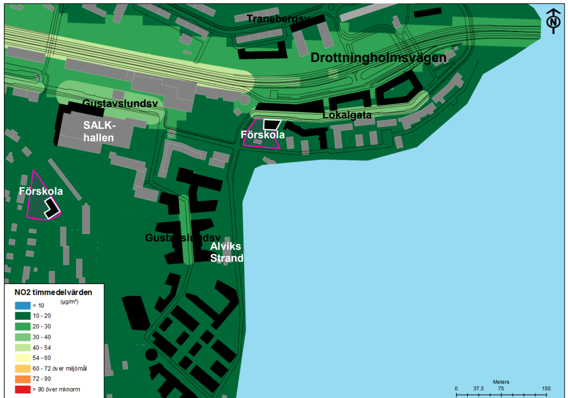
Figur 16. Timmedelvärden av NO 2 i µg/m 3 efter utbyggnaden år 2030 för de 176:e högsta värdena under kalenderåret. Normvärdet som skall klaras är 90 µg/m 3 och miljömålet 60 µg/m 3 .
