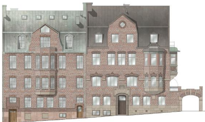
Gatufasader för Sköldungagatan 6 och 4. Befintliga fasader till vänster och fasader med rekonstruerade fönster enligt planförslag till höger.
