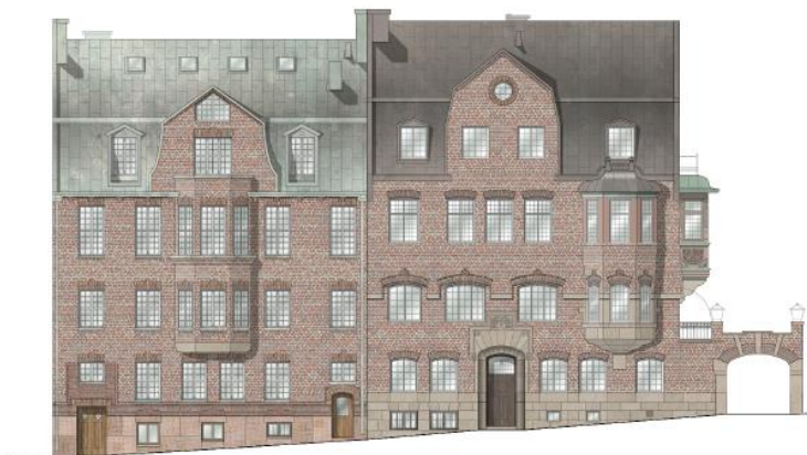
Gatufasader för Sköldungagatan 6 och 4. Befintliga fasader till vänster och fasader med rekonstruerade fönster enligt planförslag till höger.
